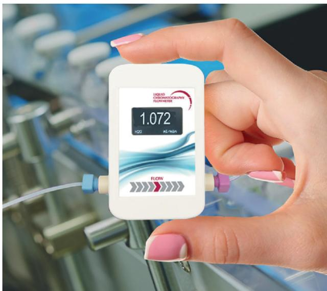
Estos caudalímetros funcionan sobre la base de una determinación térmica del caudal efectivo. Ofrecen alta precisión y exactitud, combinadas con una excelente resolución. Es de gran importancia que, a la hora de solucionar problemas, también ofrezcan una respuesta rápida que permita a los ingenieros de servicio detectar cambios en el caudal en muy poco tiempo, como ocurre cuando las válvulas de retención o las juntas de una bomba no funcionan al 100% pero aún no fallan por completo.
